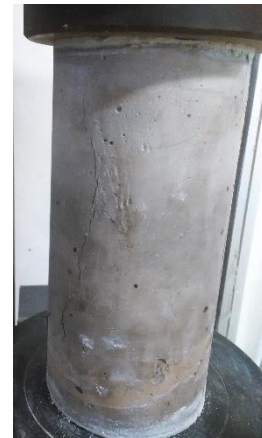
Imagen No.B4: Especímen fallado
