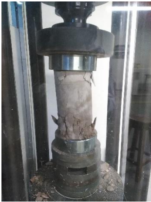
Imagen No.B1: Especímen fallado
