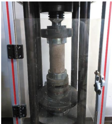
Imagen No.B3: Especímen fallado
